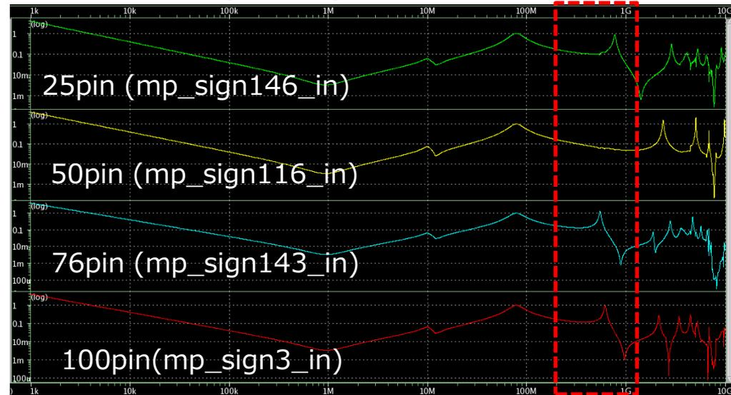
MP法simulationでの25/76/100pinに見られた700MHz付近のpeakを簡易Simで再現！50 pinでpeakがないことを確認！
