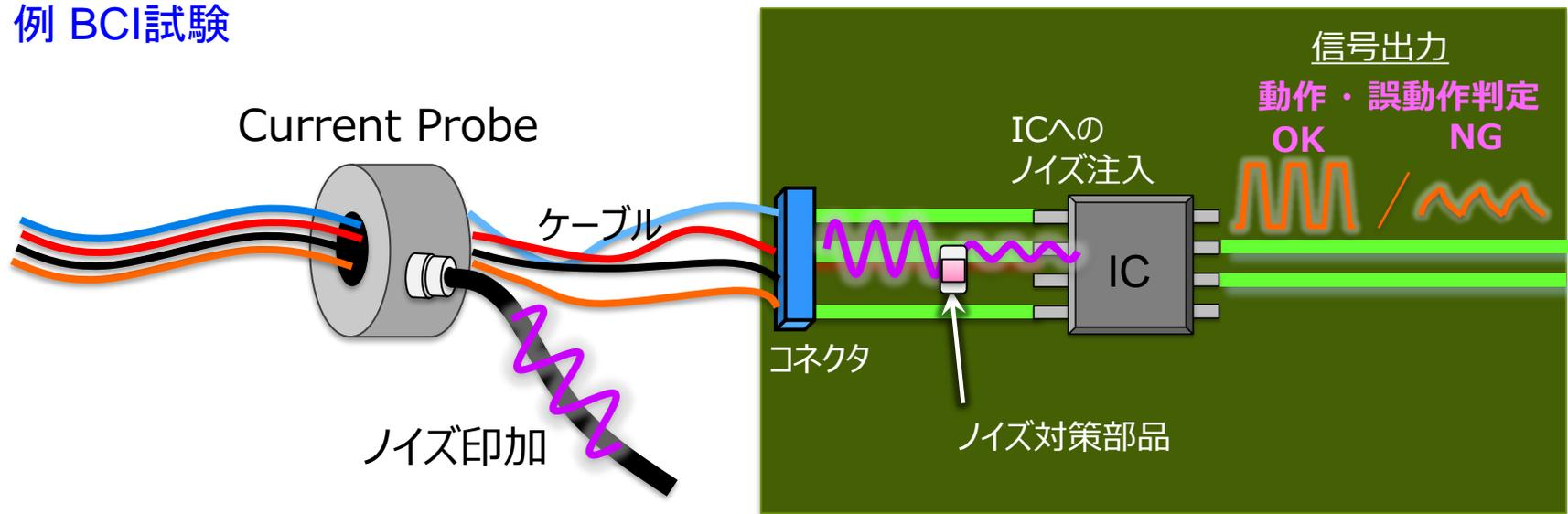
Step1 : 機器へのノイズ印加 (Current Probeのモデル)
