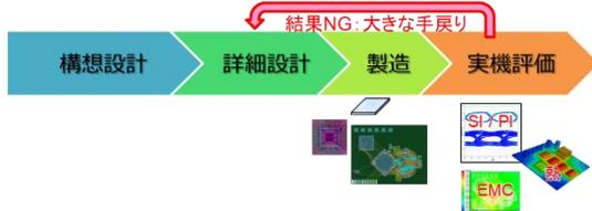
2) 試作前に構想段階と詳細設計の間の短い手戻りで設計品質を高め試作段階での手戻りを発生させない開発手法に移行しました。このとき当委員会で構想段階において設計情報を表現する書式 LPB フォーマット V2 (IEEE 2401-2015, IEC 63055 ED1) を開発し国際標準にしました。
